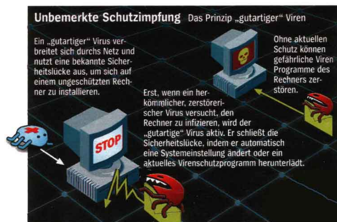
Abbildung 27: Schema zur Wirkungsweise eines gutartigen Computervirus
